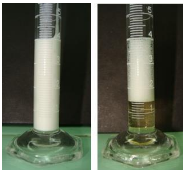
Figura 06: Estabilidade da espuma em cilindro volumétrico. Imagem da esquerda no tempo = 0 minuto e imagem da direita no tempo = 30 min.
